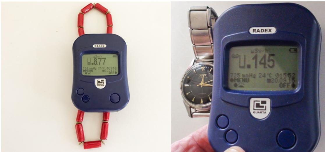
**Figur 4** Das Corpus Delicti, eine der strahlenden Halsketten, strahlt mit 8.77  $\mu\text{Sv/h}$ . Rechts: Meine alte Tissot «Seastar», getragen ca. 1955-1970, strahlt mit 14.5  $\mu\text{Sv/h}$ .
